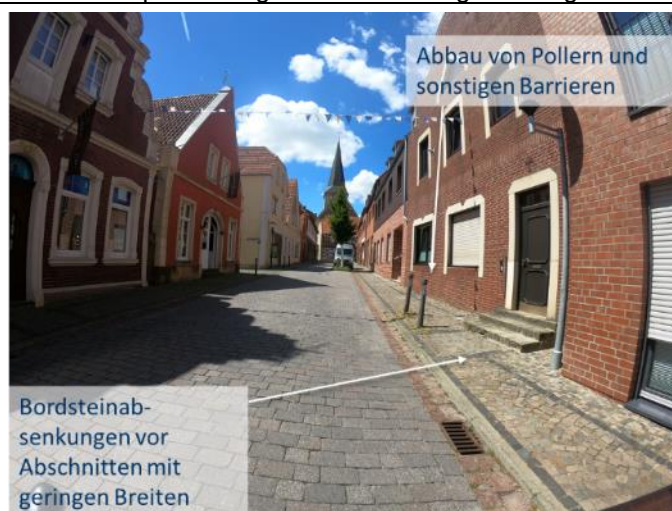
Bsp. Abbau von Pollern oder Integration Absenkungen
